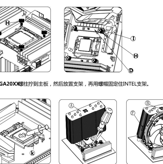
将LGA20XX螺柱拧到主板，然后放置支架，再用螺帽固定住INTEL支架。
