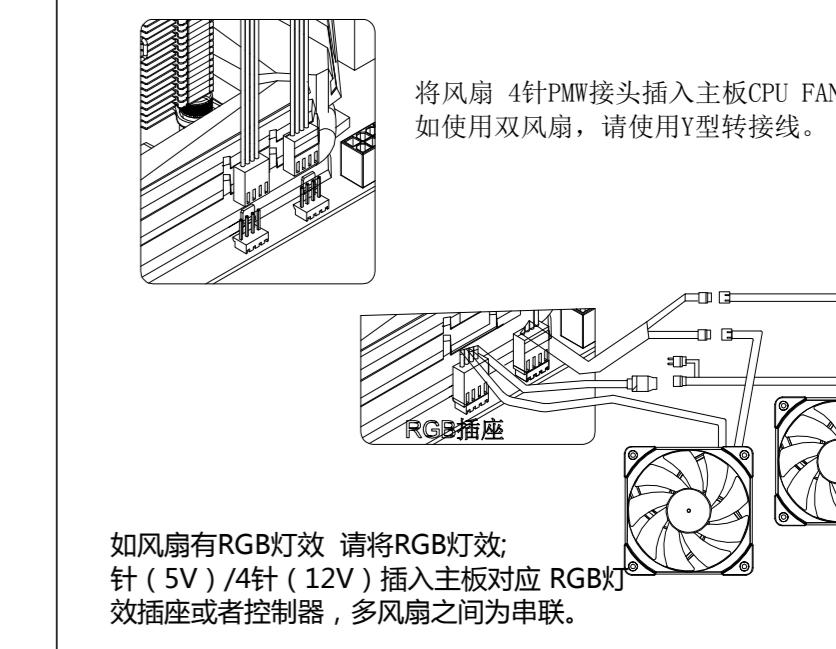
将风扇 4针PMW接头插入主板CPU FAN 插座
