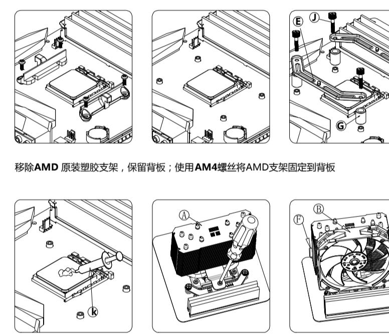
移除AMD原装塑胶支架，保留背板；使用AM4螺丝将AMD支架固定到背板。
