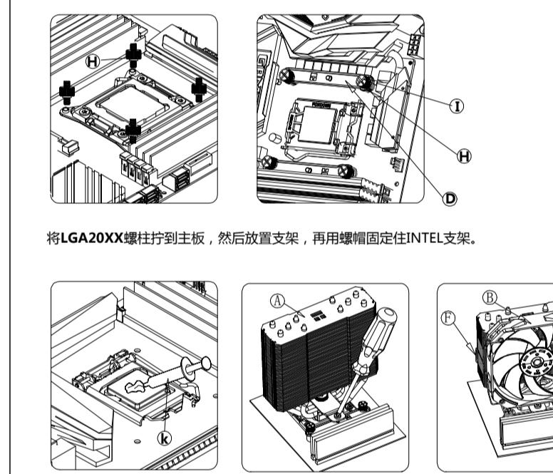
将LGA20XX螺柱拧到主板，然后放置支架，再用螺帽固定住INTEL支架。
