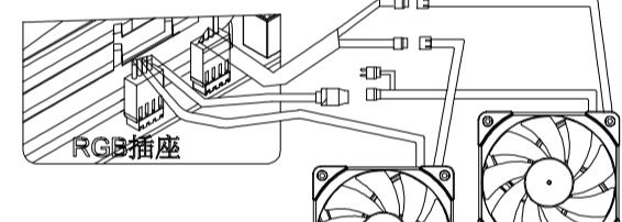
如风扇有RGB灯效，请将RGB灯效：针(5V)/4针(12V)插入主板对应RGB灯效插座或者控制器，多风扇之间为串联。
