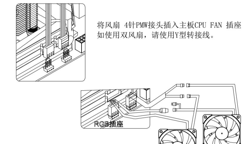
将风扇4针PWM接头插入主板CPU FAN插座如使用双风扇，请使用Y型转接线。
