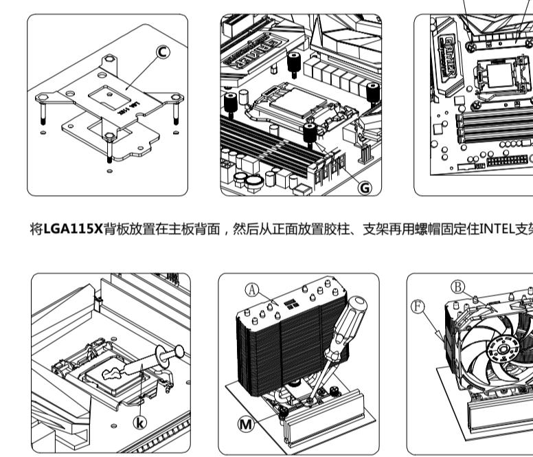
将LGA115X背板放置在主板背面，然后从正面放置胶柱、支架再用螺帽固定住INTEL支架。
